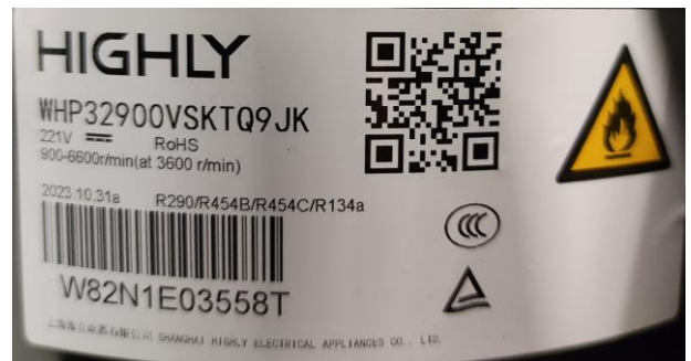
Bild 4 / Picture 4 Typenschild Verdichter Name plate compressor
