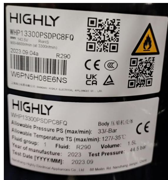
Bild 4 / Picture 4 Typenschild Verdichter Name plate compressor
